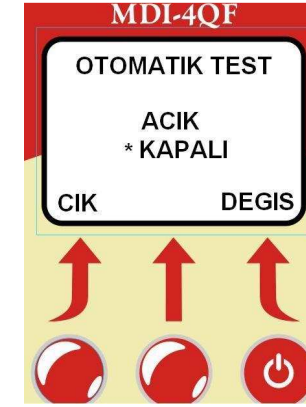
Şekil 7 : “OTO TEST” menüsü yorumlama yapılmadan, sayısal değerlerin en küçüğünün temel kabul edilip, “0” (sıfır) olarak değerlendirildiği menüdür. “OTO TEST” kullanılacaksa “DEGIS” yazısının altındaki butona basılarak OTOMATİK TEST açık hale getirilir ve kaydedip çıkmak için “CIK” yazısının altındaki butona basılır. Bu durumda Aracın versiyon bilgilerini gösteren aşağıdaki ekran görüntülenir
