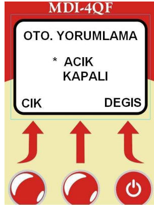
Şekil 5 : Yukarıdaki ekran görüldüğünde eğer “OTO. YORUMLAMA” kapatılacaksa “DEGIS” (Değiştir) yazısının altındaki butona basılır ve “OTO YORUMLAMA” kapatılır. Bu durumu kaydedip çıkmak için “CIK” (Çıkış) yazısının altındaki butona basılır. Otomatik yorumlama ayarı yapıldıktan sonra çıkış butonuna basıldığında bir sonraki menü olan “OTO TEST” menüsü gelir.
