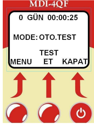
Şekil 8 : Ekranı geldiğinde ölçümler artık OTO.TEST modunda yapılacaktır. Bu moda bir test yapacak olursak aşağıdaki sonuçlar görüntülenir.
