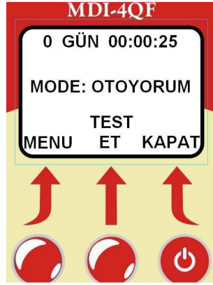
Şekil 5 : Yukarıdaki açılış ekranı görüntüledikten sonra “MENU” yazısının altındaki butona basar.
