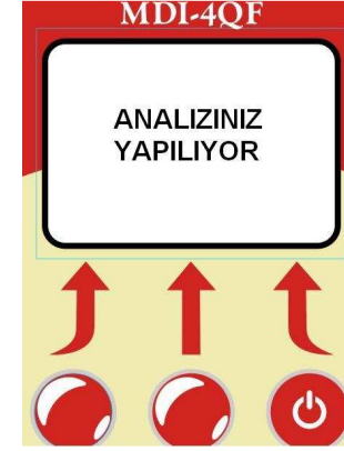
Şekil 3 : Analiz yapılmaya başlandığında yukarıdaki ekran gözükür ve gerekli uygulamalar makine tarafından çalıştırılır. Bu ekran görüntülenirken hiçbir buton çalışmaz.
